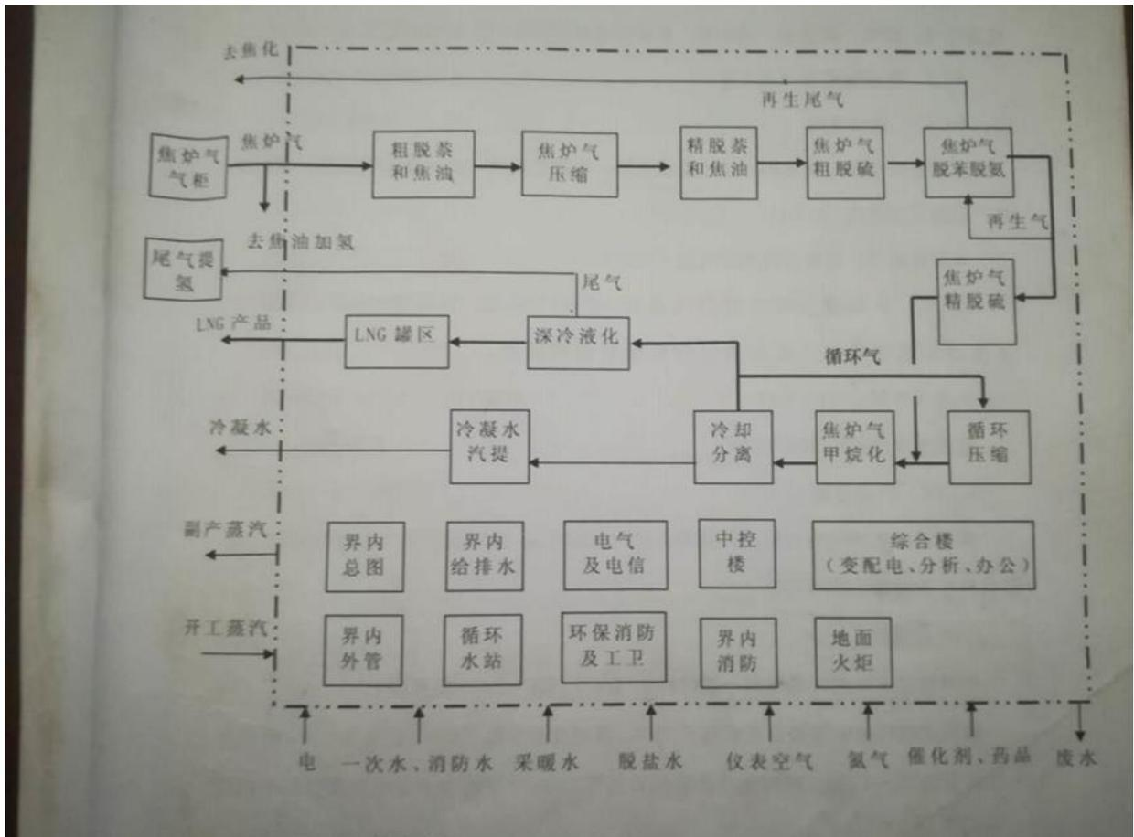
图 3-2 LNG 生产工艺流程图
